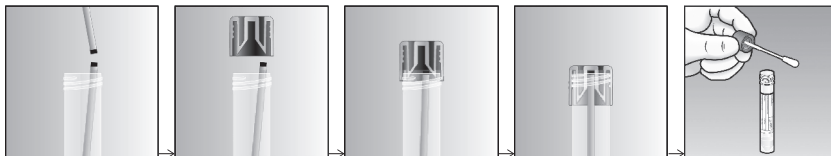
Kuva 1 – Puikon katkaistun varren kiinnittäminen MSwab®-koeputken korkkiin
