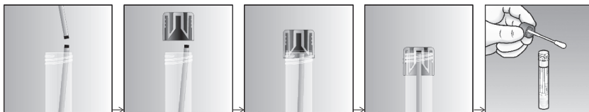
Fig. 1 - Forankring av det brutte vattpinneskaftet i korken på MSwab®-reagensrøret
