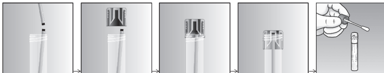
Фиг. 1 – Улавяне на счупената дръжка на тампона в капачката на епруветката за проби MSwab®
