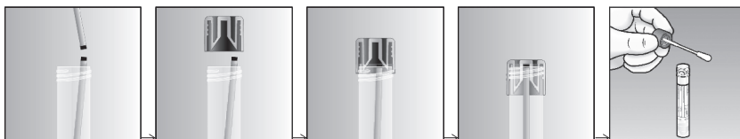
Afb. 1 - Afbeelding van de afgebroken schacht van het staafje in de dop van het MSwab®-testbuisje
