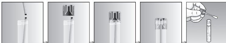
Fig. 1. Ancoraggio dell'asta spezzata del tampone da parte del tappo della provetta MSwab®
