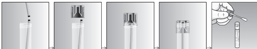
Fig. 1 – Insamling av det trasiga pinnskafet i locket på MSwab®-provrör
