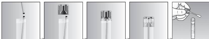
Fig. 1 - Capture de la tige brisée de l'écouvillon dans le bouchon du tube à essai MSwab®
